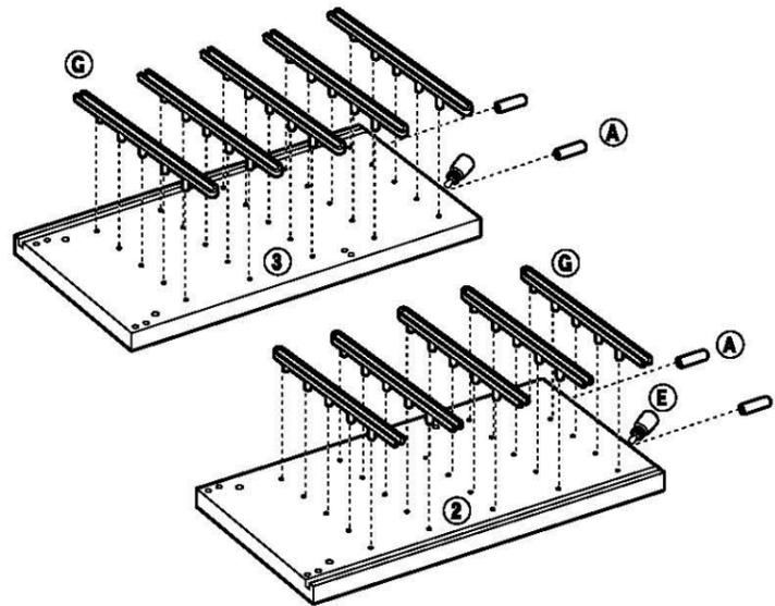
STEP 4 ⑤仕切り板に⑥引出しレール、④木ダボ(太)を取り付けてください。
