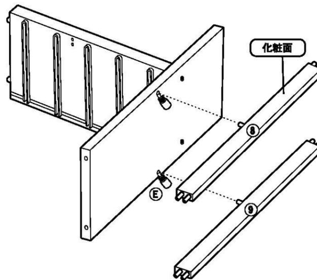
STEP 8 本体に⑥左補強板を取り付けてください。次に、②左側板を取り付けてください。
